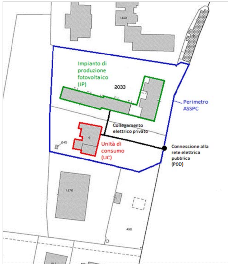
Figura 5: Rappresentazione del perimetro di un ASSPC semplice caratterizzato da un impianto di produzione e un unità di consumo
