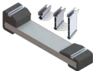
Ecozav05 è testato nella galleria del vento e sottoposto a prove di strappo in condizioni climatiche estreme da -20°C a +80°C. I supporti sono in appoggio sulla superficie e non richiedono di essere fissati tramite tasselli o altri sistemi di ancoraggio.
