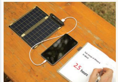
Si chiama Solar Paper il caricabatterie solare prodotto dalla startup Yolk che si può comodamente inserire tra le pagine di un libro. I moduli fotovoltaici hanno uno spessore di soli 1,5 millimetri e sono modulari, grazie ad un aggancio magnetico posto sul bordo. Una coppia di moduli da 2,5 W è in grado di ricaricare la batteria di uno smartphone in due ore e mezza.
