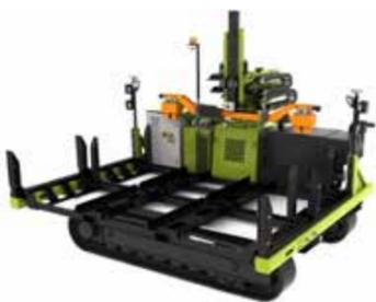
parco solare per posizionare i pali durante la realizzazione di nuovi impianti fotovoltaici su larga scala. La macchina è in grado di effettuare tutte le operazioni senza la guida diretta di un operatore. Quest'ultimo potrà controllare il lavoro da remoto via computer. In più, grazie a specifici sensori, questa soluzione garantisce sicurezza agli operatori eventualmente presenti in campo.
