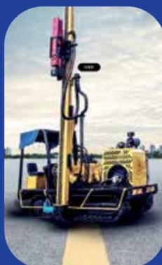
Il **BATTIPALO** per pali fotovoltaici è uno strumento essenziale utilizzato durante l'installazione di impianti fotovoltaici. Si tratta di un macchinario progettato per guidare i pali nel terreno in modo efficiente e preciso.
