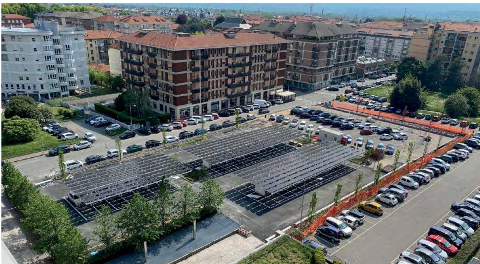
**P**resso il parcheggio della nuova sede del gruppo bancario Sella a Biella sono state installate pensiline fotovoltaiche a copertura di 112 posti auto. La struttura delle pensiline è stata fornita da RCM mentre la progettazione è stata sviluppata dal cliente su disegno dell'architetto Francesco Bermond Des Ambrois dello Studio FBdA Fabbrica di Architettura. In totale l'installazione occupa una superficie di 1.400 metri quadrati per una potenza complessiva pari a 250 kWp.
