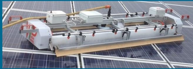
• **Serie MM o MMV**, soluzioni manuali per impianti shed a tetto o campi fotovoltaici di potenza modeste ~1 MW. Le macchine sono poste dall'operatore sulle file o tetto da lavare e vengono gestite manualmente con una autonomia delle batterie di 8h. L'operatore rimane sempre sul colmo in sicurezza presso la linea vita. Pressione dell'acquedotto senza idropulitrici e in assoluto silenzio senza motori a scoppio.
