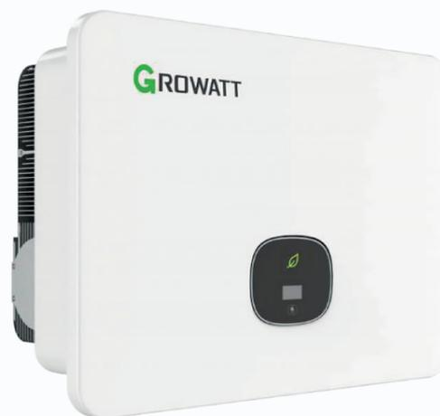
L'inverter MID50K ha 4 tracker MPP per un totale di otto stringhe collegabili, protezione IP66, una corrente di stringa massima aumentata e corrispondente a 16A per stringa, scaricatori in classe II in ingresso e uscita lato AC e DC e funzione Afci contro l'arco elettrico. È infine dotato di interfacce USB e RS485 che lo rendono compatibile con la Smart Key per snellire il processo installativo, ma ha anche un LCD frontale alfanumerico che agevola la prima installazione».
