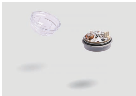
P5-ZS2 È UN DISPOSITIVO WIRELESS PER IL TELECONTROLLO PUNTO-PUNTO DELL'ILLUMINAZIONE E NODO DI UNA RETE IOT
