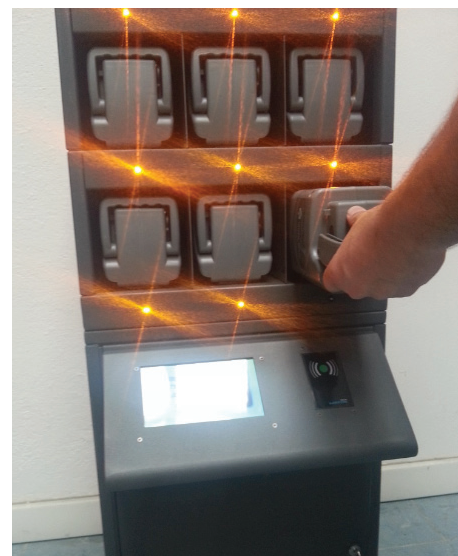
UTILIZZANDO LA SMART CARD I CICLISTI IN POCHI MINUTI POTRANNO SCAMBIARE LA BATTERIA ESAURITA CON UNA CARICA
