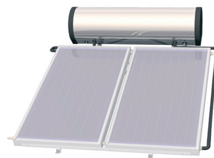
GLI IMPIANTI SOLARI TERMICI A CIRCOLAZIONE NATURALE, COSTITUITI DALL'ACCUMULO SITUATO ALL'ESTERNO SOPRA IL COLLETTORE, VENGONO GENERALMENTE UTILIZZATI NELLE ZONE NON SOGGETTE AL GELO INVERNALE
