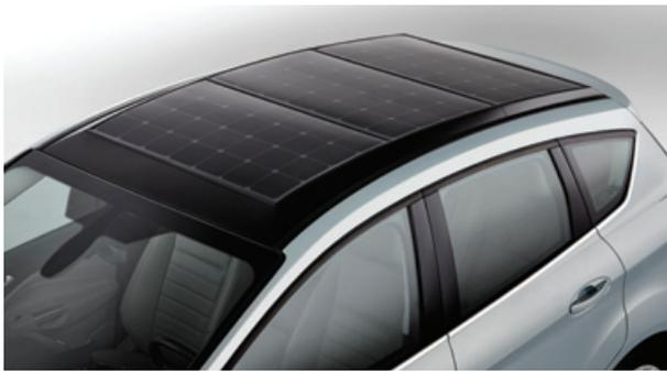
LA VETTURA IBRIDA C-MAX SOLAR DI CASA FORD COMBINA UN PROPULSORE AD ENERGIA SOLARE AD UNO TRADIZIONALE A BENZINA. IL SISTEMA DI PANNELLI MONTATO SUL TETTuccio FORNISCE LA CARICA ALLE BATTERIE AL LITIO CHE ALIMENTANO LA SPINTA ELETTRICA
