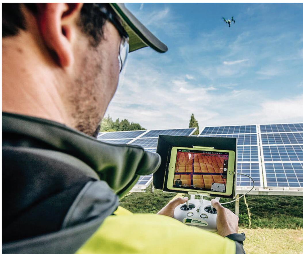
I DRONI STANNO MAN MANO SOSTITUENDO LA PRESENZA IN CAMPO DEGLI OPERATORI. ESSENDO IN GRADO DI CONTROLLARE E MONITORARE 1 MW DI IMPIANTO FOTOVOLTAICO IN POCCHISSIMO TEMPO. I DISPOSITIVI, INOLTRE, OGGI SONO MOLTO PIÙ PUNTUALI E PRECISI NELL'ANALISI DI EVENTUALI ANOMALIE SU MODULI E INVERTER
